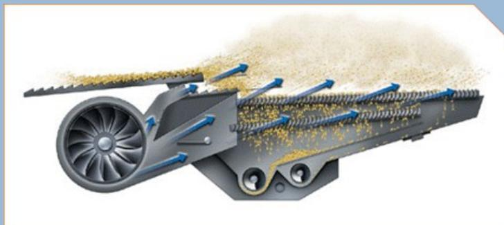
Figura 4. Sistema de limpeza.
